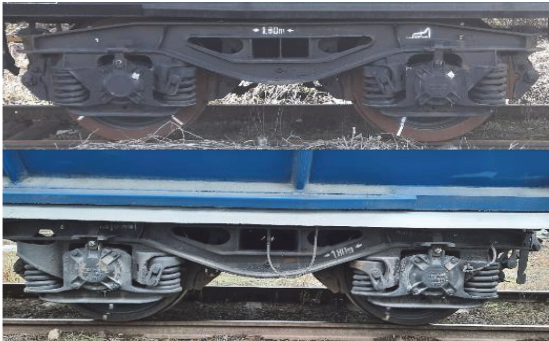
Foto comparativ privind accesul la pietrele de frecare vagon seria Fals (sus) și vagon seria Fals cu prelungire a pantei fixe(jos)
